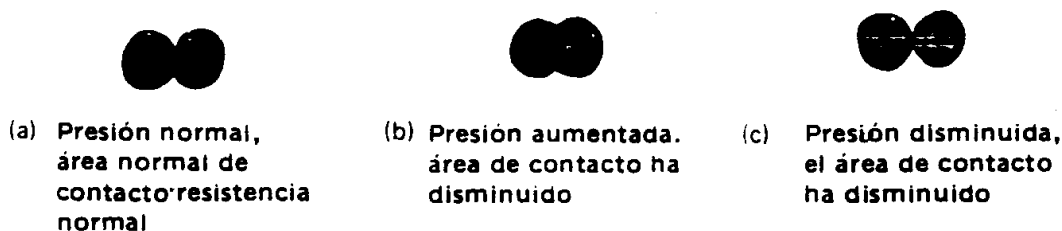
Fig. 9.— Ilustración de la variación de resistencia del transmisor de gránulos de carbón.
